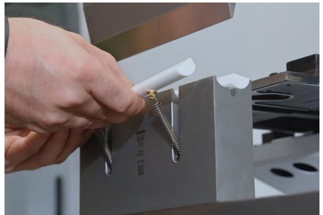
Werkzeugloser Tausch der Kunststoffbacken
